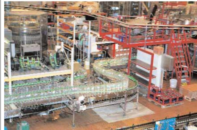
Пять линий работает в две смены. Одна круговая машина разливает 35 тысяч бутылок в час
